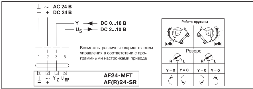
Схема электрических соединений
